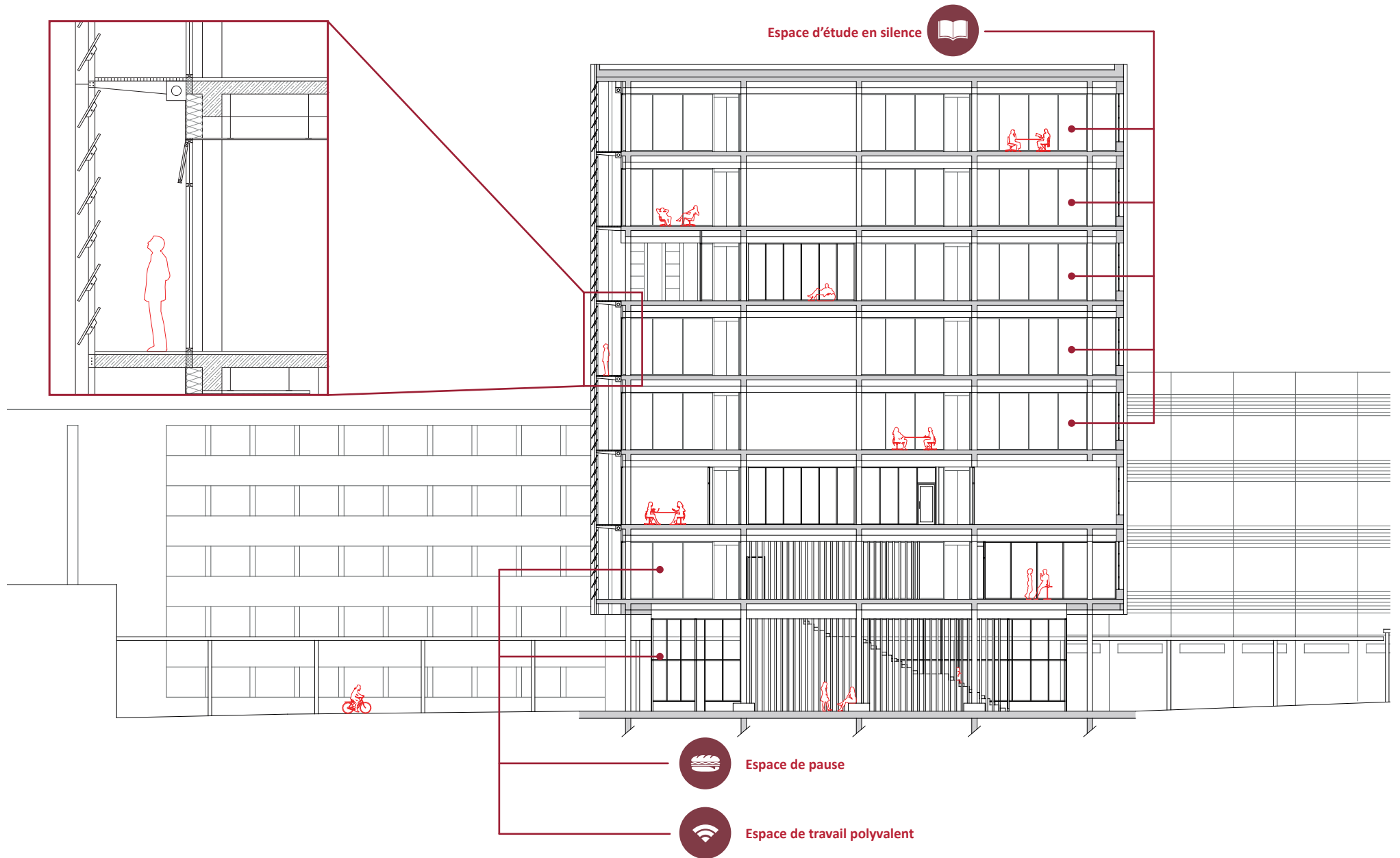
Coupe longitudinale du learning center Détail de façade avec le système de double peau
